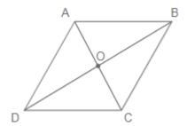
Uma das propriedades dos paralelogramos nos diz que o ponto de intersecção das diagonais ocorre nos **pontos médios** dessas diagonais. Isso significa que esse ponto divide cada diagonal em duas partes congruentes entre si. Sendo assim, temos **AO=CO**, bem como **DO=BO**
